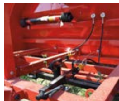
ZPM-180 önálló fékrendszer
