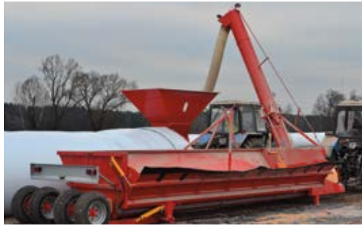
ZPM-180 gabonatöltés fóliatömlőbe BNP-12 vagonrakóval és ZPM-180 fóliatöltővel
